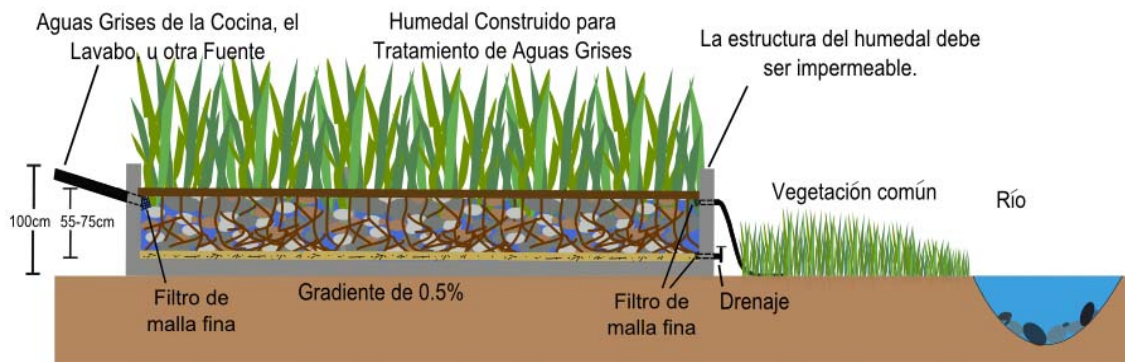
Figura 1. Un sistema subterráneo típico de humedales construidos
